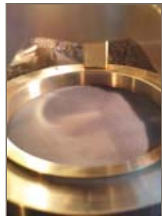
織物經PUD處理後，耐水壓測試
